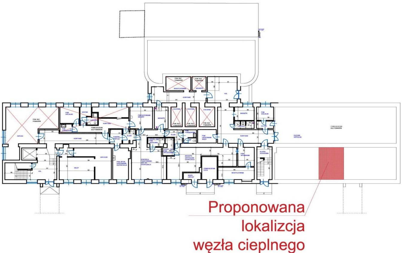
Rys. 7. Proponowana lokalizacja węzła – Budynek B
